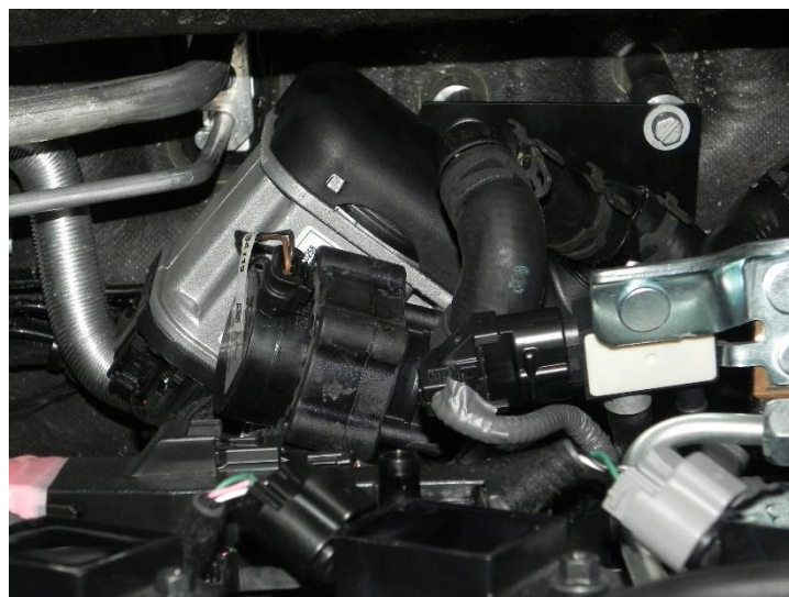
agregat i pompa wody
