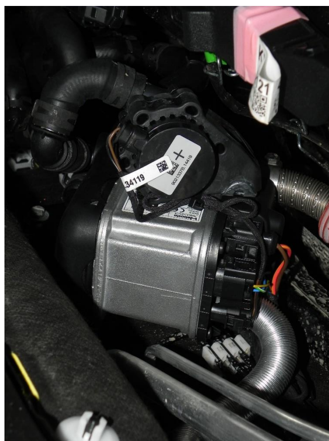
agregat i pompa wody
